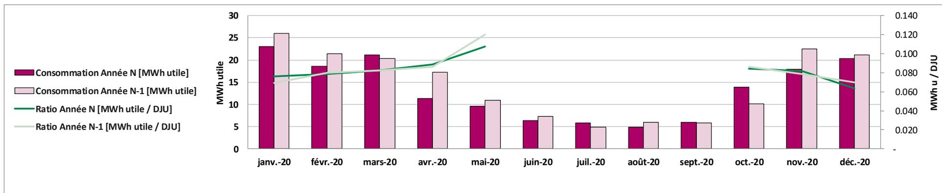
**FIGURE 5 : QUANTITE D'ENERGIE MENSUELLE DES SOUS-STATIONS N°5**
